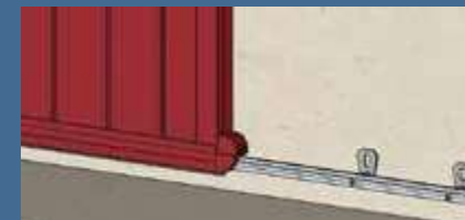
Réglette support en partie basse pour porte-fenêtre
